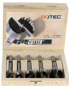
**Exécution:** Selon la norme DIN 7483 G, avec une pointe de centrage, une coupe périphérique ondulée et 2 copeaux. Queue cylindrique avec 3 méplats décollée de 30 mm de longueur.
