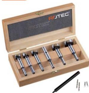
**Exécution:** Selon DIN 7483G, pointes et forets de centrage interchangeables. Coupe circulaire ondulée brevetée, 2 couteaux et queue conique à 3 méplats.
