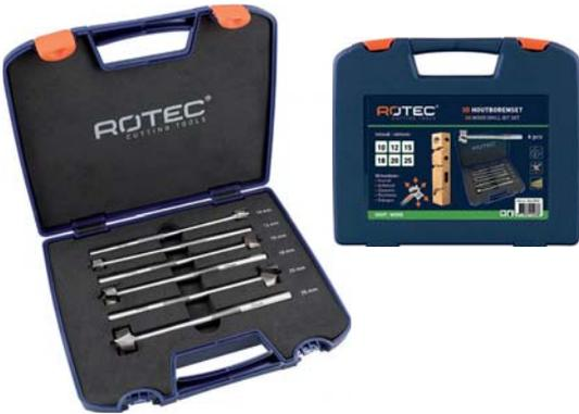
**Exécution:** Mèche Forstner 3D à bois en acier SP (acier spécial) de haute qualité. La queue rectifiée à 3 méplats empêche le glissement dans le mandrin de la perceuse. Les tranchants affûtés et le col réduit en diamètre permettent d'utiliser la mèche dans toutes les directions.
