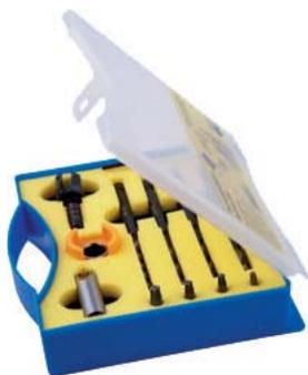
**Exécution:** Les forets et fraiseurs sont en métal HSS, fabriqués d'une seule pièce (embout non collé et non soudé) en métal trempé, queue 6 pans 1/4" résistant à de forte sollicitation.
