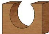
**Exécution:** A double tranchant. Pour obtenir des rainures rondes sous une pièce, ex. gaines ou rigoles. En cas d'utilisation de toute la fraise à pleine profondeur, il faut d'abord fraiser une rainure qui garantit ensuite le passage de la queue.
