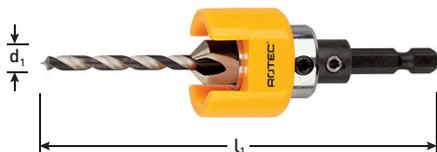
**Exécution:** Le foret à bois et fraiseur sont en métal HSS, fabriqués d'une seule pièce (embout non collé et non soudé) en métal trempé, queue 6 pans 1/4" résistant à de forte sollicitation.
