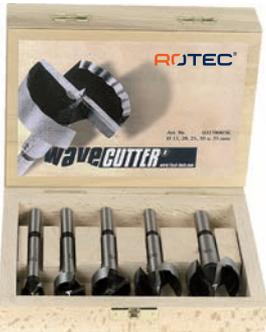
**Exécution:** Selon la norme DIN 7483 G, avec une pointe de centrage, une coupe périphérique ondulée et 2 coupeaux. Queue cylindrique avec 3 méplats décollée de 30 mm de longueur.
